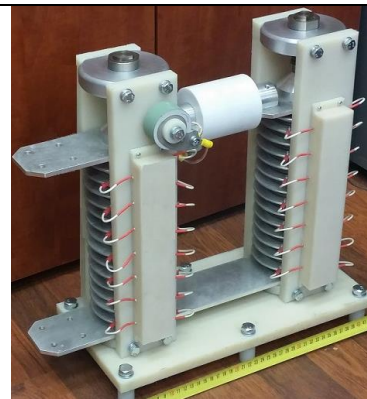
Рис. 21. РВД-коммутатор цепи предионизации ламп накачки.
